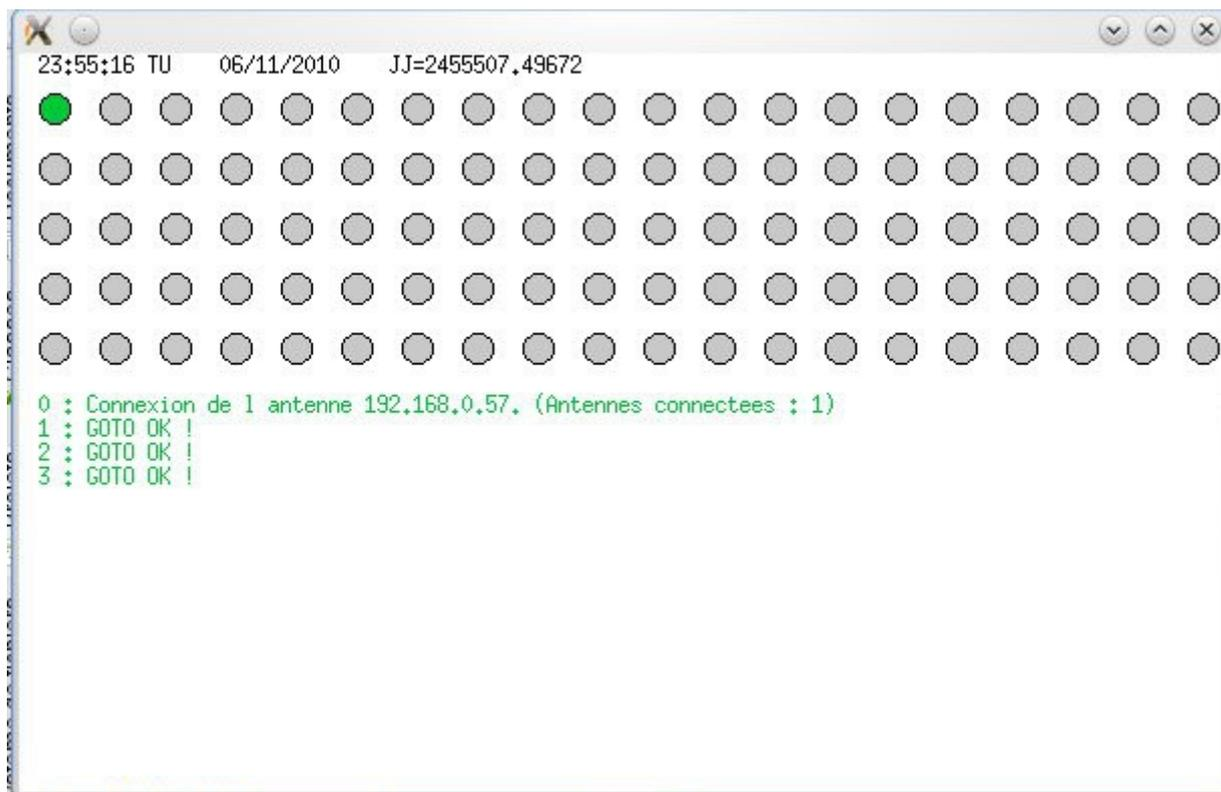
Les cercles représentent les antennes (ici il y en a 100) présentes sur l'installation BAORadio. Les cercles gris représentent les antennes non connectées et les cercles verts indiquent des antennes fonctionnant normalement. En cas d'erreur sur une antenne, le cercle correspondant devient rouge et un message également en rouge apparaît dans la liste des derniers messages envoyés par les antennes.
