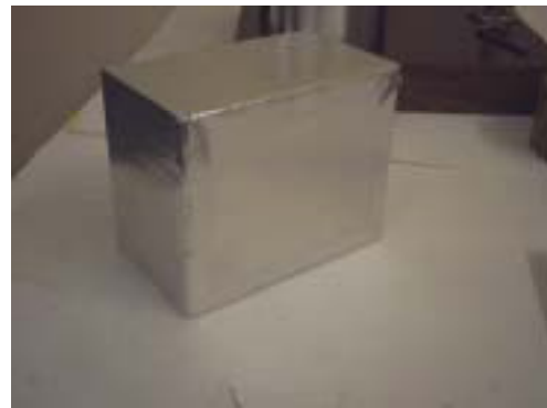
Fig. 2, Al tape wrapping
