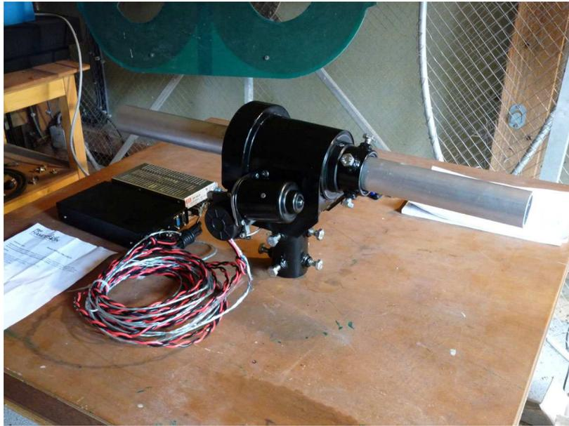
Figure 3 : Le motoréducteur HamDesign en position de mesure, avec à gauche son alimentation (bloc brillant) et son convertisseur (bloc noir)
