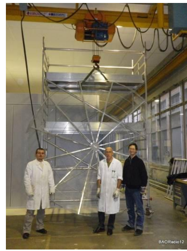
Figure 5 A gauche : réflecteur de 3.5m de diamètre d'origine chinoise monté sur un pied et une monture conçus et réalisés au LAL. A droite : réflecteur de 3m de diamètre de la firme hollandaise RF HAMDesign.
