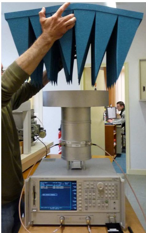
Figure 1 : Mesure de l'adaptation et de la réjection à l'analyseur de réseaux avec de l'absorbant devant l'ouverture
