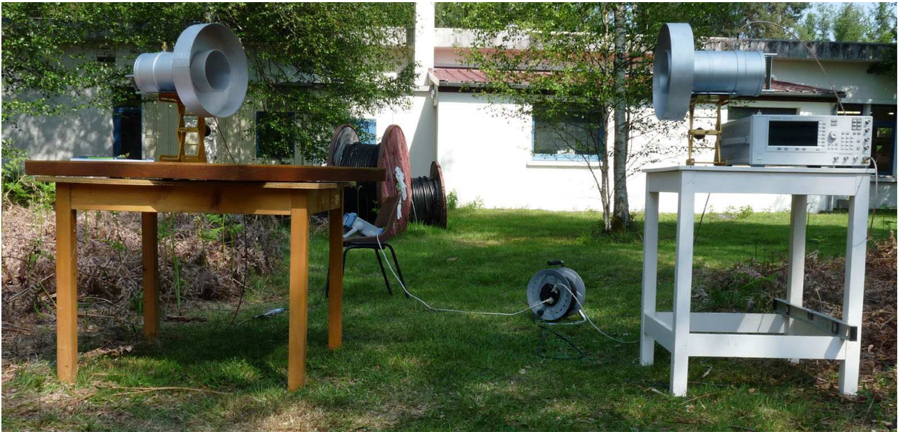
Figure 5 : Banc de mesure du diagramme de rayonnement (photo du haut : vue de l'Est, photo du bas : vue de l'Ouest)
