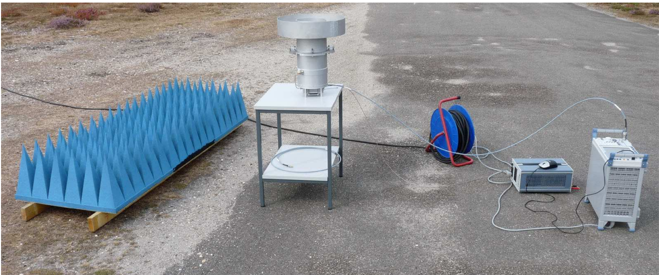
Figure 3 : Banc de mesure de Tsys (à droite l'analyseur de spectres, à gauche la plaque d'absorbant)
