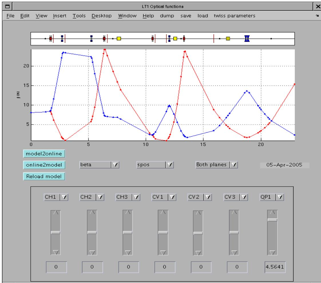
Illustration 11.1: Application de simulation et réglage de l'optique de LT1
