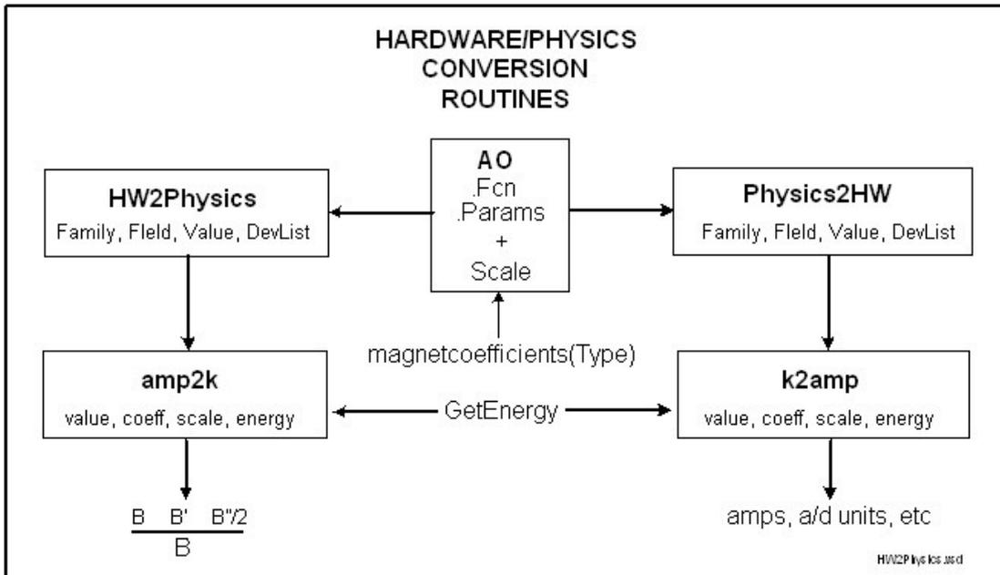
Illustration 7.1: Schéma de fonctionnement des commandes amp2k et k2amp (SPEAR3)
