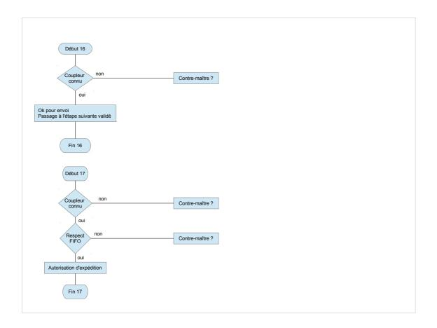
FIFO: les coupleurs doivent dans la mesure du possible être expédiés dans le même ordre que l'ordre d'arrivée. Cela permet de limiter la perte de vide dans les coupleurs.
